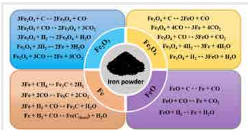
(شکل ۱: واکنش‌های احیا و کربوره شدن در مراحل مختلف احیای اکسیدهای آهن)
